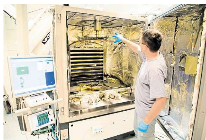
V laboratoři Výzkumník Libor Nožka před takzvanou vakuovou napařovací aparaturou v laboratoři RCPTM-SLO. Foto: SLO
